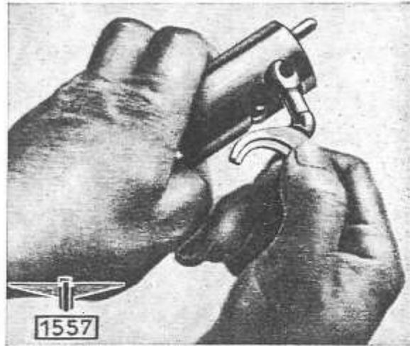
**Abb. 9. Schaltgabeln in Schaltzylinder stecken.**
